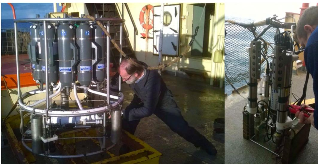
**Foto 10:** CTD con roseta (izq.) y sin roseta (der.), este último con dos sensores SBE37 montados para intercalibrar.
