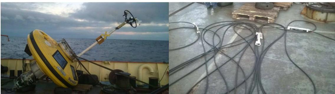
**Foto 9:** Boya oceánica en cubierta de popa antes de ser fondeada (izq.) y maniobra de MicoCATs sobre cable inductivo lista a ser fondeada.
