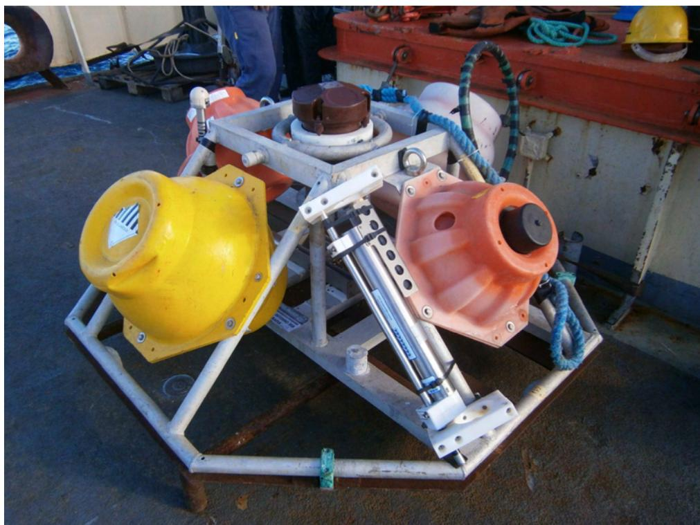
**Foto 7:** Domo listo para ser fondeado y fijación de MicroCAT con barra de acero inoxidable y adaptadores diseñados originalmente para montar un mareógrafo SBE26plus.
