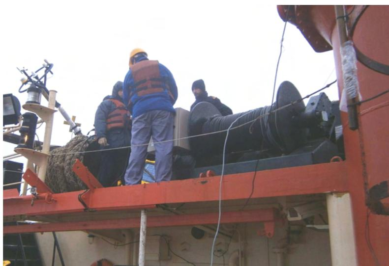
**Foto 2:** Guinche para maniobra de fondeo instalado en cubierta 01 del PD
