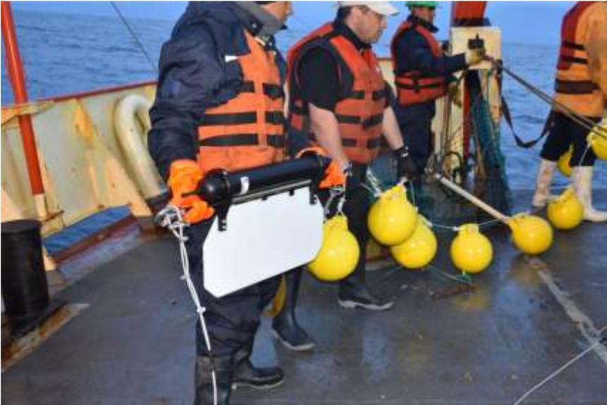
**Fig. 8.4.1.** Correntómetro Aquadopp a punto de ser fondeado. Foto: Alex Martínez
