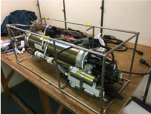
Figura 1: Unidad sumergible CTD-BO Austral con sus sensores primarios, secundarios y auxiliares.
