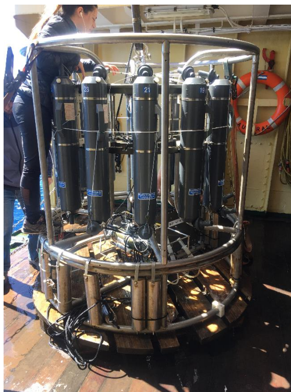
Figura 2: Unidad CTD/Roseta armada con 12 botellas.
