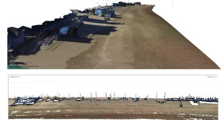
Ortomosaico (Arriba) y nube de puntos densa (Abajo) de la zona de playa de Monte Hermoso, obtenidos mediante Structure from Motion y drone
