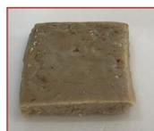
**Deshidratación:** entre ciclos, se drenó el líquido en exceso con tela de algodón. Luego del segundo ciclo, el líquido se eliminó por centrifugación (5 min, 2800 rpm).
