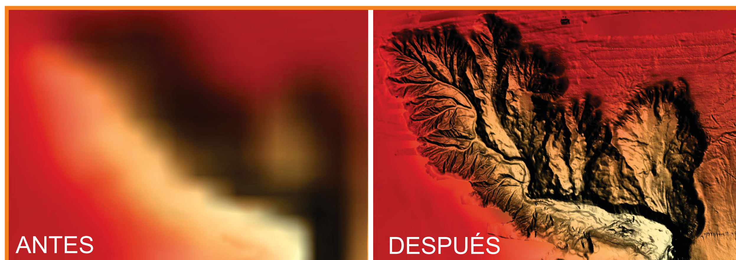
Figura 6: Comparación entre las grillas batimétricas públicas (GEBCO) y la grilla batimétrica multihaz de alta resolución adquirida.
