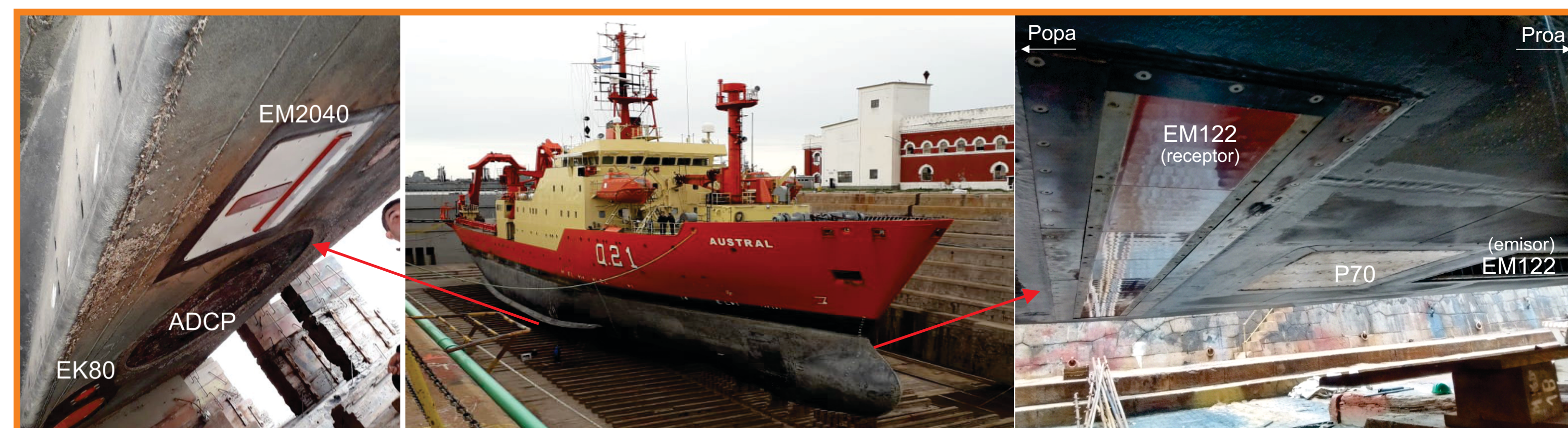
Figura 1: Ubicación de los equipos acústicos instalados en el casco del Buque Oceanográfico Austral del CONICET.
