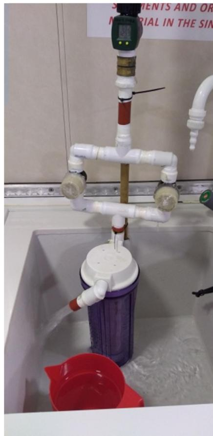
**Figura 14.2.** Sistema de filtrado conectado a la red de agua corriente marina del BIPA.
